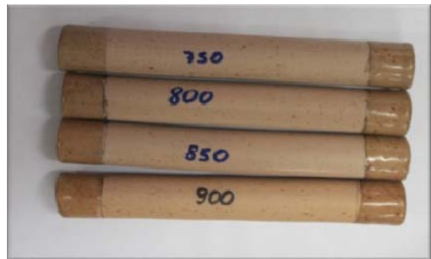
Figura 1. Membranas cerâmicas tubulares sinterizadas a 750°C, 800°C, 850°C e 900°C
